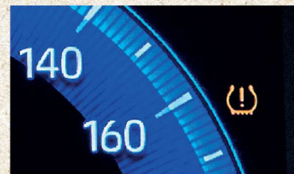
Tire Pressure Monitoring System ระบบแจ้งเตือนเมื่อลมยางผิดปกติ
