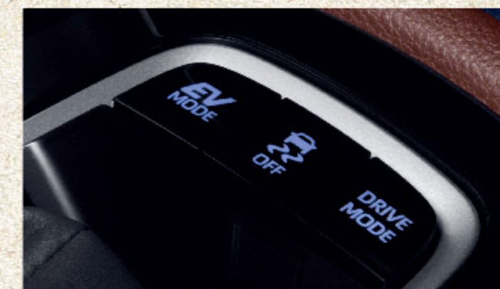
EV MODE ใช้กำลังจากมอเตอร์ไฟฟ้าเพื่อการเดินทางที่เงียบสนิท SPORT MODE เพิ่มสมรรถนะในการขับขี่ และตอบสนองอัตราเร่งได้ดียิ่งขึ้น ECO MODE ช่วยลดการใช้พลังงานที่สิ้นเปลือง เพื่อการใช้พลังงานอย่างมีประสิทธิภาพ
